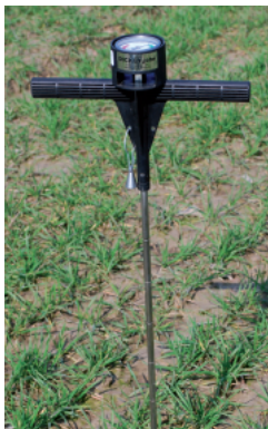
Instrumente zur Messung des Eindringwiderstandes v. l.: Handsonde, mech. Penetrometer, elektr. Penetrologger
