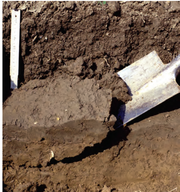
Abb. 19: Ausstechen eines Bodenblocks im Bereich der Pflugsohle: Im Bild ist eine verdichtete, verlassene Krumenschicht erkennbar
