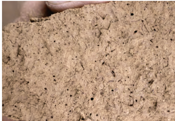
Abb. 30: Kohärentgefüge, günstig (Gefügestrukturnote 2), Löss in ursprünglicher Lagerung, locker, zahlreiche Grobporen
