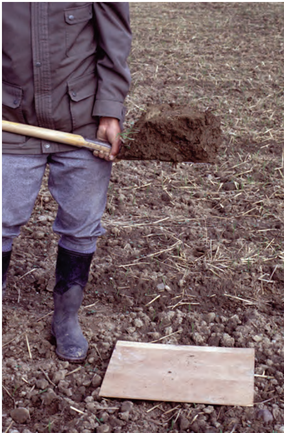
Abb. 13: Beim Aufprall auf eine feste Unterlage (Brett) zerfällt der Bodenblock in seine natürlichen Gefügeaggregate
