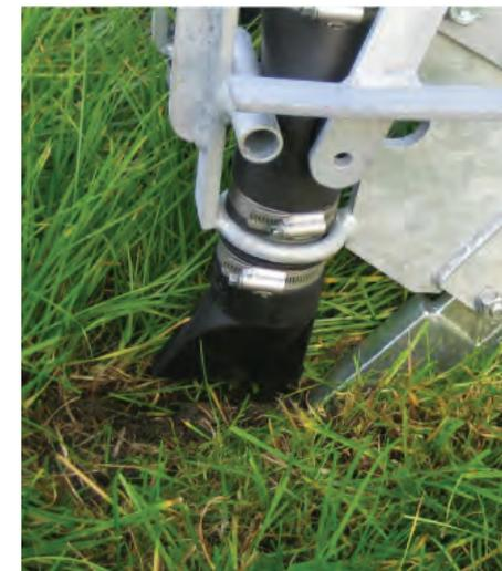
**Abbildung 7:** Detailaufnahme der Gülleinjektionstechnik (Foto: M. Hofmeier)
