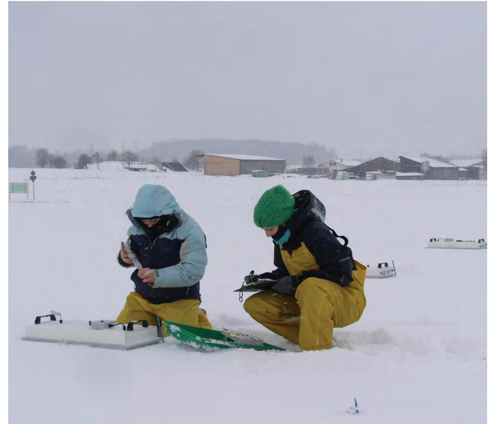
Abbildung 14: Erfassung der N<sub>2</sub>O-Emission im Winter auf Versuchsflächen der Universität Hohenheim mittels installierter Bodenhauben, in denen sich das aus dem Boden emittierende N<sub>2</sub>O anreichert. Die Gasprobenahme aus den Hauben erfolgt manuell mit einer Spitze (Foto: K. Kesenheimer)
