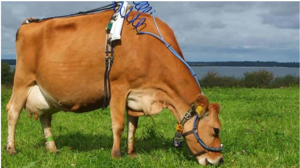
*Mit einem Abgasmessgerät wurde der Methanausstoß der Kühe ermittelt. (Bildquelle: Malisch)*
