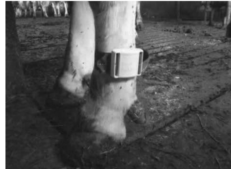
Pedometer am Bein einer Kuh zur Erfassung der Aktivität und des Liegeverhaltens
