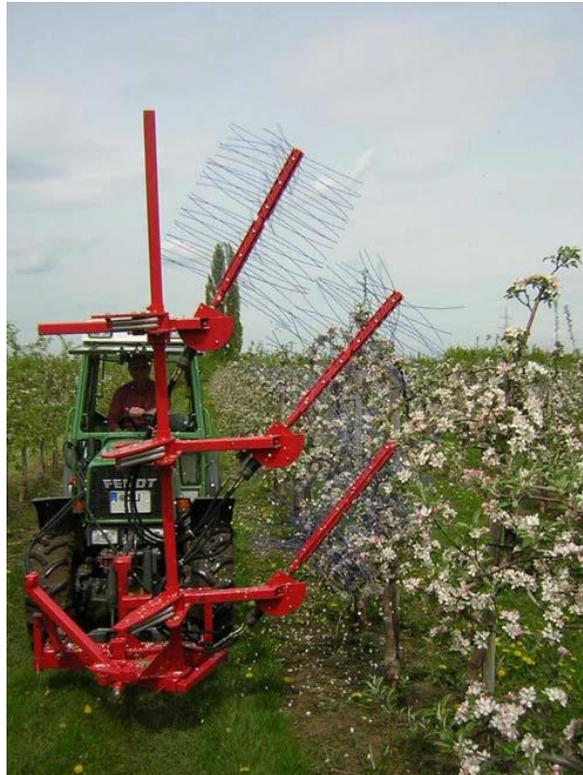
**Abbildung 8.** Ausdünnmaschine `Flexitree` (Typ Bonn) der Firma Clemens GmbH & CO KG aus Wittlich. Entwickelt von L. Damerow und M. Blanke an der Universität Bonn (Damerow et al. 2007a).
