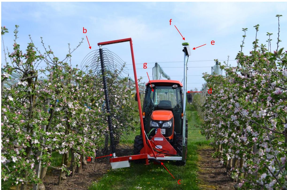
**Abbildung 9.** Weiterentwicklung der `Darwin`-Maschine der Firma Fruit-Tec (Markdorf) mit dem SmaArt-System zur automatischen Regulierung der Spindeldrehzahl entsprechend der Anzahl an Blüten. (a) funktionale Einheit der `Darwin`-Spindel, (b) Fadenelemente mit 60 cm langen Fäden, (c) Steuerung, (d) Halterung für Kamera und GPS-Antenne, (e) Kamera, (f) GPS-Antenne und (g) Boardcomputer.
